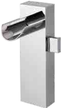
Ref. 8402C Misturador com cartucho progressivo para lavatório. Tipo cascata. Bica alta, indicada para cuba de apoio. Acabamento cromado. Vazão: 6 l/min. com 8 m.c.a. Acompanha ligação de flexível de 50 cm. Diâmetro do furo para instalação: ø 3,5 cm. Pressão recomendada: 8 m.c.a. até 10 m.c.a.
