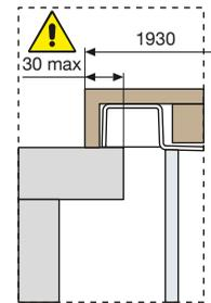
Detalhe para caso de instalação de embutir
