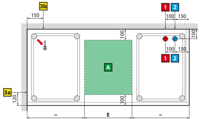
Detalhe para caso de instalação de embutir
