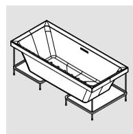
Sistema autoportante de altura ajustável
